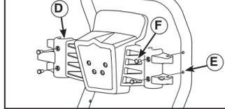
**AVIS** En desserrant les deux boutons de la partie médiane du boulon de fixation, la poignée supérieure peut être pliée vers l'avant afin de la ranger sur le moteur refroidi. **NE REPLIEZ PAS** la poignée lorsque le moteur est chaud.
